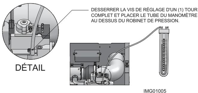
**Figure 7-6** Vérification de l'alimentation en gaz d'entrée
