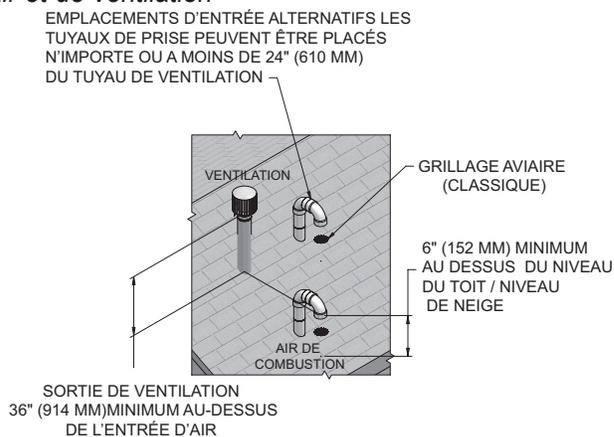
8. Situer les terminaisons de façon qu'elles ne puissent pas être endommagées par des objets étrangers, comme des pierres ou des balles, ou susceptibles d'accumuler des feuilles ou des sédiments.
