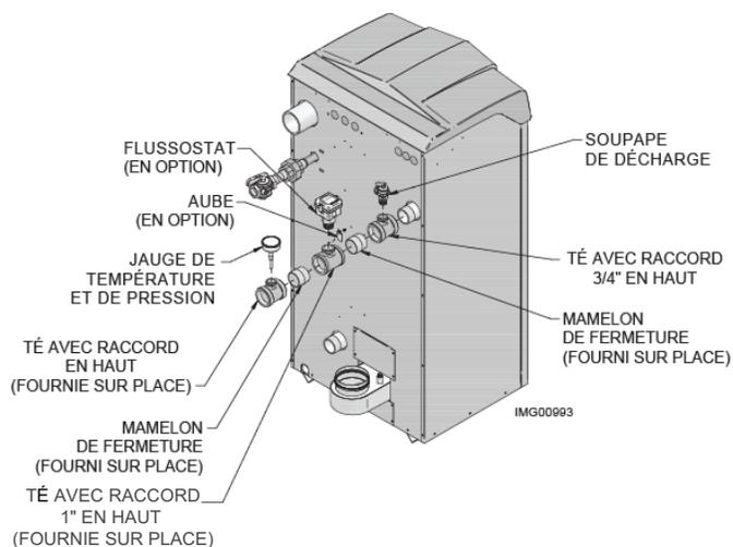
**Figure 6-2** Pose du flussostat, de la soupape de décharge et de la jauge de température et de pression\_Modèles 725 – 850
