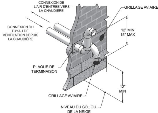
3. La tuyauterie d'air doit se terminer sur un coude tourné vers le bas, comme indiqué à la FIG. 4-1A. Cette disposition empêche toute recirculation des produits de combustion dans le courant d'air de combustion.
