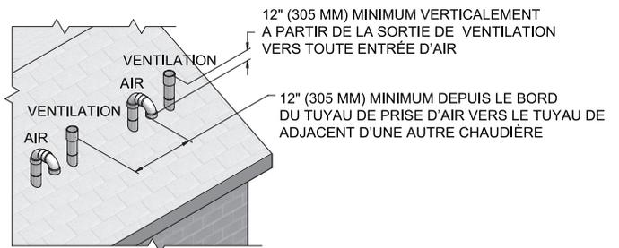
**Figure 5-3** Terminaisons verticales alternatives avec chaudières multiples
