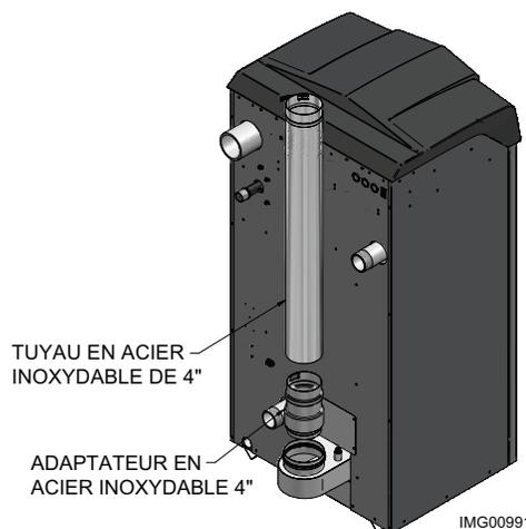
**Figure 3-7** Près de la ventilation en acier inoxydable du chaudière modèles 725 - 850
