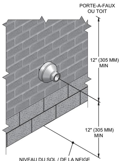
3. Découpez un (1) orifice (7 pouces (178 mm) de diamètre pour les installations n° 100140484) dans la structure pour installer le kit de terminaison.
