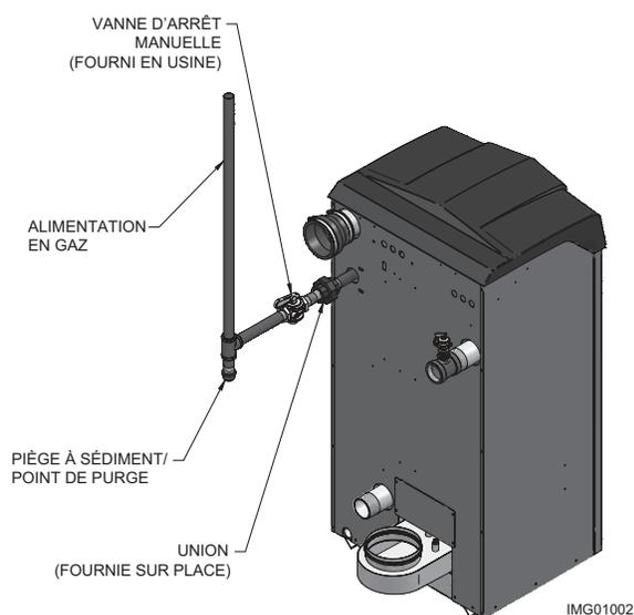
**Figure 7-2** Tuyauterie d'alimentation en gaz - Modèles 725 - 850
